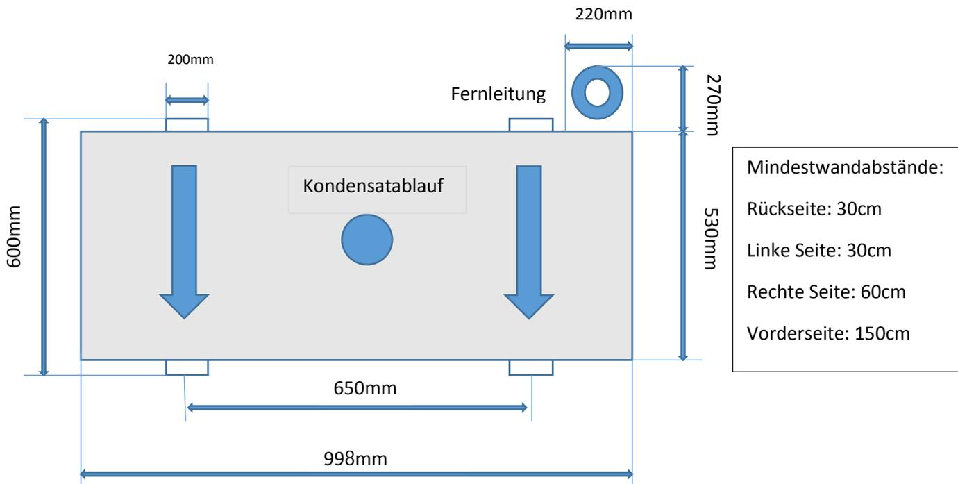
Bei der Aufstellung der Außengeräte ist auf eine Entkopplung der Außeneinheit zu dem restlichen Baukörper zu achten. Dies ist sowohl bei Wandmontage als auch bei bodenstehender Montage zu berücksichtigen.
